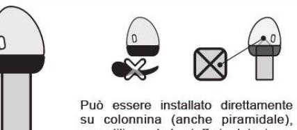
Può essere installato direttamente su colonnina (anche piramidale), non utilizzando la staffa in dotazione.
