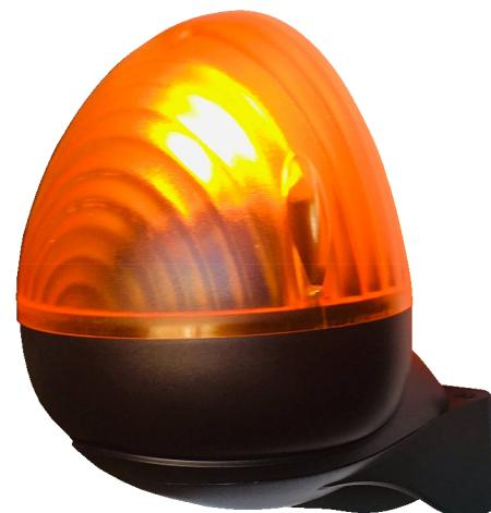
**ST-FLB** Lampeggiatore tronco cono. Intermittenza elettronica, Circuito 9+9 Led alimentazione da 12 a 24 Vacdc. Tempo lampeggi a 12 V 40/minuto a 24 V 45/minuto. Selezione funzioni Luce fissa o lampeggiante. Installazione a parete, o palo, adatto per segnalare il movimento di cancelli automatici. Contenitore plastico ABS. Calotta metacrilato arancio. Protezione IP44. Composto da base con fori di fissaggio e calotta. Dimensioni Ø114XH148XØ120 mm. Peso 245 gr.
