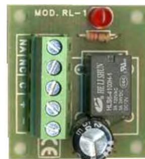
**SS-RLC** Interfaccia per l'accoppiamento di circuiti. Polarizzato e protetto contro inversione di polarità. Segnalazione funzioni tramite led. Alimentazione 12 Vac.. Bobina resistenza 720 Ω. Relè 1 scambio 1 A 24 V. Utile per qualsiasi applicazione e circuito elettronico. Dimensioni L40XL36XH18 mm. Peso 14 gr.
