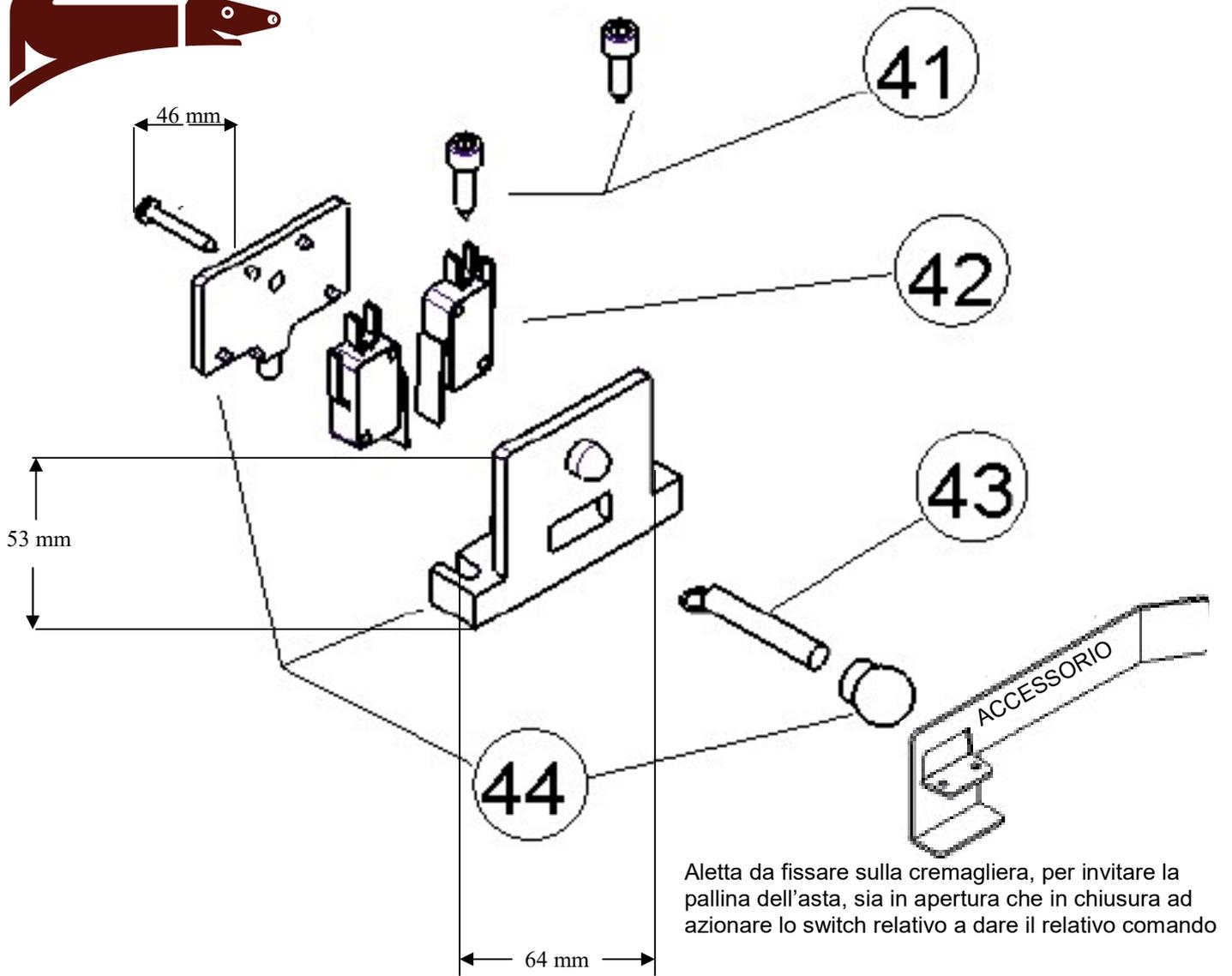
Le dimensioni riguardano il corpo i contatti sono Faston standard esterni e sono espresse in mm
