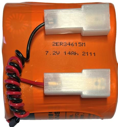
**SF-CRB** Pacco Batteria da 2 Pile litio ER34615M 7,2 V 14 Ah collegate in serie non ricaricabili. Collegamento esterno tramite connettore (Sostituibile vedi disegno), con terminali polarizzati per ricambio Sirene radio Securvera; e altre marche. Lunghezza fili circa 100 mm. Forma parallelepipedo irregolare, Involucro in guaina termorestringente. Direttiva ISO 9001 Dimensioni d'ingombro H62XL69Ø34 mm Peso 231 gr
