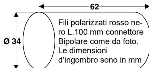
**SB-BLS** Pile litio ER34615M 3,6 V 14 Ah non ricaricabile. Collegamento esterno tramite connettore (Sostituibile vedi disegno), con terminali polarizzati per ricambio Sirene radio Securvera; e altre marche. Lunghezza fili circa 100 mm. Forma tronco cilindrica irregolare, Involucro in guaina termorestringente. Dimensioni d'ingombro H62XL69Ø34 mm Peso 231 gr. Direttiva ISO 9001 UL, UN38.3 Certificata RoHS
