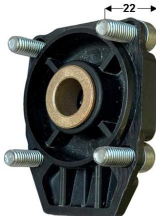
**SV-CAP** Coperchio Anteriore (121332) con bronzina porta vite senza fine, 4 viti per il fissaggio sulla testa del motore. Adatto per motori PM1 SC; PM2 SC; PM3 SC; SV-MBS; SV-MBQ; SV-MBC. Costruito con plastica speciale. Figura irregolare. Dimensione di ingombro L50XH62XS12XØ145XØB11,5 mm. Peso 265 gr.
