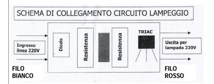
SV-ELA Elettronica lampeggiante a mezzo Triac. Intermittenza elettronica, lampada incandescenza. Ripetitore di allarme remoto, oppure su cancelli automatici, cicli di lavorazione. Alimentazione 220 V 50 Hz. Supporta lampade potenza fino a 20 W. Protetta da involucro al silicone. Collegamento con 4 fili. Dimensioni H24XL26XS16 mm. Peso 0,03 gr.
