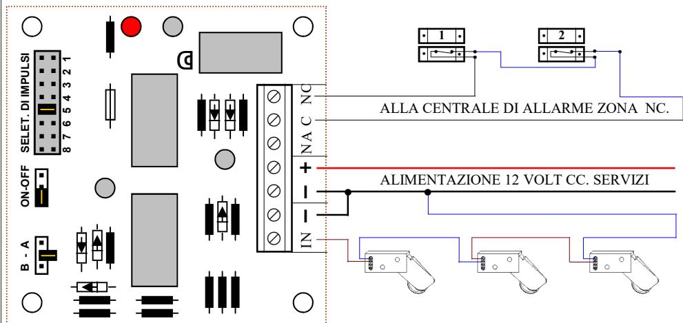
ESEMPIO DI COLLEGAMENTO SU UNA CENTRALE DI ALLARME VIA RADIO, TRAMITE IL MODULO AMPLIFICATORE IL QUALE LO RENDE FUNZIONALE CON LA NOSTRA CENTRALE DI ALLARME RADIO, E NE REGOLA LE FUNZIO-
