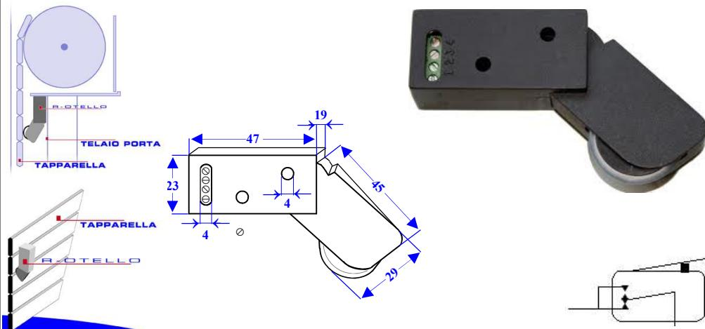
**SE-RCM** Rotello **rivelatore di rotazione** brevettato. Corrente massima di transito **1 A 250 V**. Il giro della ruota provoca **l'apertura del contatto per circa 50 mS.** (necessita dell'amplificatore conta impulsi **SV-MSI**). Adatto per rivelare il sollevamento di serrande e tapparelle. Installare in modo che lo **snodo** a molla tocchi la serranda. Contenitore ABS forma rettangolare snodabile. Dimensioni base L82XL22XS19 mm. Peso 0,16 Kg.
