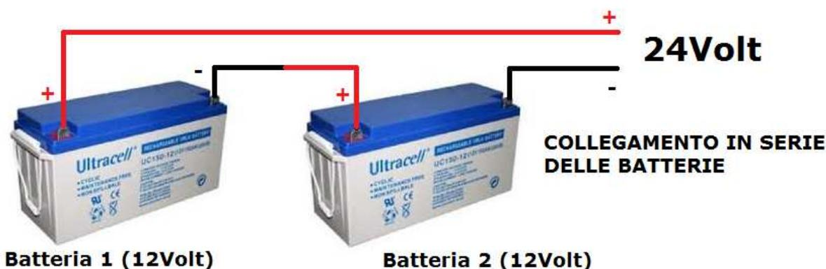
Sia nei collegamenti in serie che per quelli in parallelo, le batterie devono sempre essere di capacità (Ah) uguale tra loro e, possibilmente, dello stesso lotto/anno di produzione, nonché adeguate nel valore di capacità (Ah), in modo da poter ottenere un idoneo valore di accumulo, in grado di gestire sia l'energia prodotta dai pannelli, che tutti gli assorbimenti degli apparecchi elettrici collegati alla linea di alimentazione.
