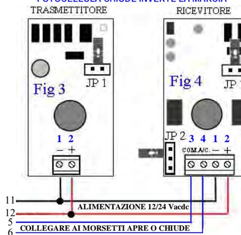
1-2 Alimentazione 24 Vca. In parallelo Morsetti 1 in centrale sul morsetto 11. Morsetti 2 in centrale sul morsetto 12. Controlla lo Jumper della fotocellula che sia in **posizione 24 Vac**.
