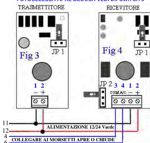
1-2 Alimentazione 24 Vca. In parallelo Morsetti 1 in centrale sul morsetto 11. Morsetti 2 in centrale sul morsetto 12. Controlla lo Jumper della fotocellula che sia in **posizione 24 Vac**.
