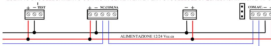
ESEMPIO DI COLLEGAMENTO RIFERITO ALLE FOTOCELLULE TIPO SV-TEC- ATTENERSI SEMPRE AL MANUALE FOTOCELLULE
