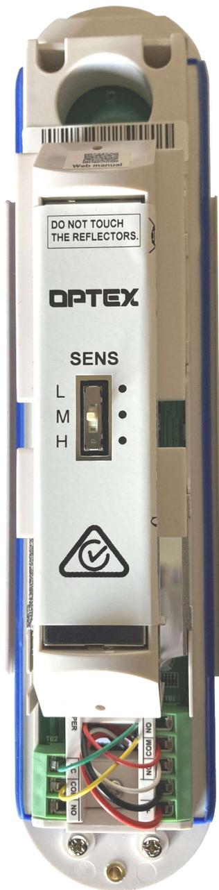
Alimentare con la batteria da 3,6 al litio in dotazione del trasmettitore SV-CTR, attenersi alle regolazioni riportate nelle pagine precedenti, chiudere il sensore e fissarlo in modo stabile.
