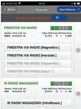
Per l'acquisizione di un sensore radio, è necessario prima abilitare il Ricevitore 868 Bloccato impostando su NO il suo cursore. Dopodichè è sufficiente inserire la batteria nel nuovo sensore da apprendere. Cliccare su Start Refresh per un aggiornamento continuo della pagina.
