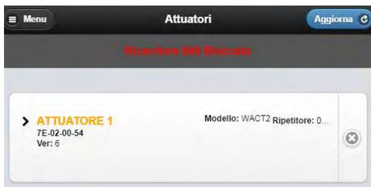
riconoscimento dell'attuatore avviene al risveglio dell'attuatore stesso aggiungendosi alla lista, la successiva fase di abbinamento viene eseguita al salvataggio dei parametri (Configurazione Attuatore).La cancellazione dell' attuatore avviene tramite il pulsante
