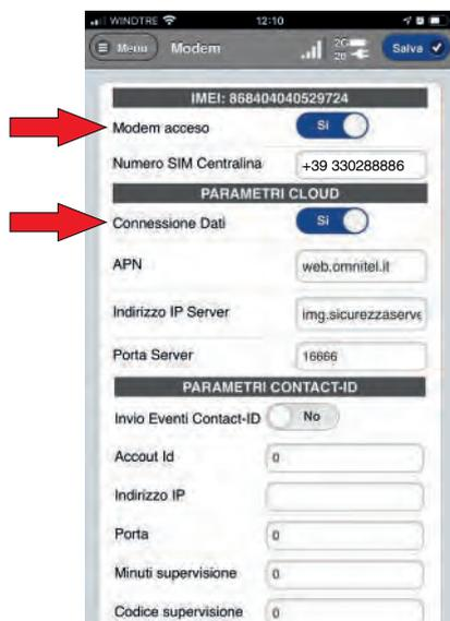
selezionare per utilizzare solo connessione gprs
