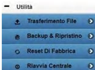
**Reset Di Fabbrica.** Effettua il reset di fabbrica della centralina. Il reset di fabbrica cancella tutta la configurazione della centralina ma non cancella le configurazioni del WiFi e del Modem.
