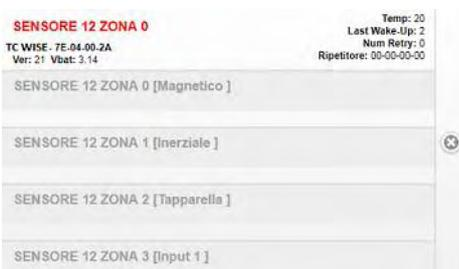
**Magnetico.** Sensore magnetico integrato: Tipo reed, tramite magnete. Magnetico a filo esterno.
