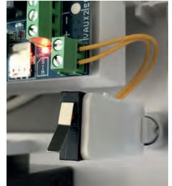
NOTA: il micro pulsante SW1 sulla scheda si trova in parallelo allo switch del tamper
