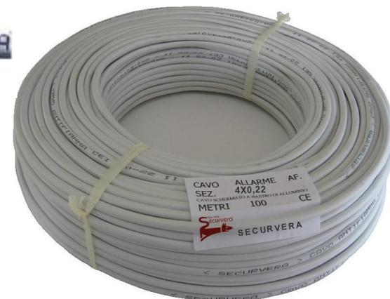
**SM-CS4** Cavo schermato flessibile antifiamma GR2 4XØ0,22 mm<sup>2</sup>. Sistema twistato, con nastro poliestere, schermo in alluminio 9/12 micron applicato secondo le norme CEI 46/5. CEI 20-22 III (IEC 60332-3) Filo di drenaggio rame rosso 7 capillari. **Speciale per impianti d'allarme**. Isolamento 1000 Vcc. Dimensioni esterne Ø 4,0 mm. Fornito in matasse da 100 metri, confezionato a macchina, protetto da busta trasparente plastica. Peso matassa 1,650 Kg.
