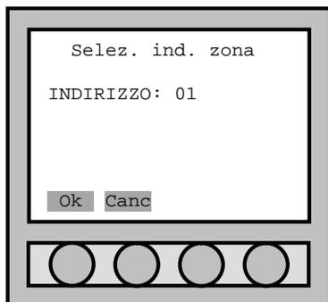
La centrale fornisce l'indirizzo della prima zona utile. Tramite la tastiera numerica si inserisce la zona prescelta.
