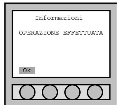
L'acquisizione del punto da parte della centrale viene rilevata con un beep e con il messaggio "OPERAZIONE EFFETTUATA" sul display.
