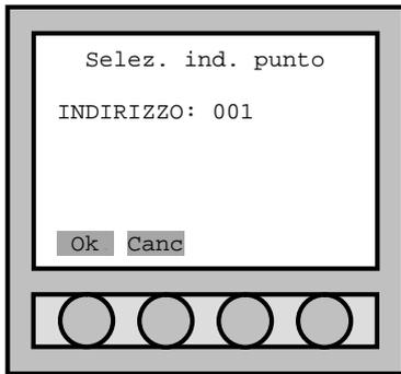
La centrale fornisce il primo indirizzo libero da programmare, relativo al loop scelto. Mediante la tastiera numerica è possibile assegnare un diverso numero di indirizzo.
