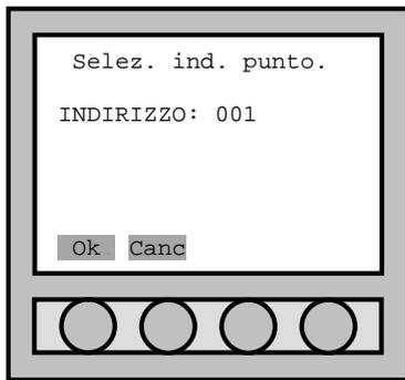
La centrale fornisce l'indirizzo del primo punto indirizzato. Mediante la tastiera numerica è possibile selezionare l'indirizzo del punto che si vuole visualizzare.
