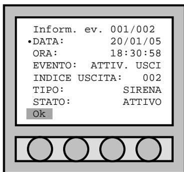
Il menù uscite attive permette di verificare lo stato delle uscite e l'indirizzo dell'uscita attivata.
