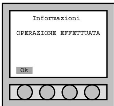
L'acquisizione del punto da parte della centrale viene rilevata con un beep e con il messaggio "OPERAZIONE EFFETTUATA" sul display.
