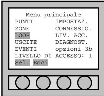
La procedura di avviamento di ogni loop va eseguita una sola volta. Entrare al “**Menù principale**” e selezionare “**LOOP**” utilizzando le quattro frecce poste sotto il display (vedi “come selezionare una scelta dal menù della centrale”). Confermare con “**sel.**” la scelta effettuata per passare al “**Menù loop**”.
