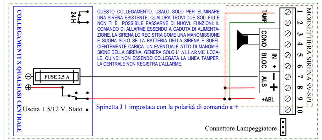
QUESTO COLLEGAMENTO, USALO SOLO PER ELIMINARE UNA SIRENA ESISTENTE, QUALORA TROVI DUE SOLI FILI E NON TI È POSSIBILE PASSARNE DI NUOVI. FUNZIONI: IL COMANDO DI ALLARME ESSENDO A CADUTA DI ALIMENTAZIONE, LA SIRENA LO REGISTRA COME UNA MANOMISSIONE E SUONA SOLO SE LA BATTERIA DELLA SIRENA È SUFFICIENTEMENTE CARICA. UN EVENTUALE ATTO DI MANOMISSIONE DELLA SIRENA, GENERA SOLO L' ALLARME LOCALE, QUINDI NON ESSENDO COLLEGATA LA LINEA TAMPER, LA CENTRALE NON REGISTRA L'ALLARME.
