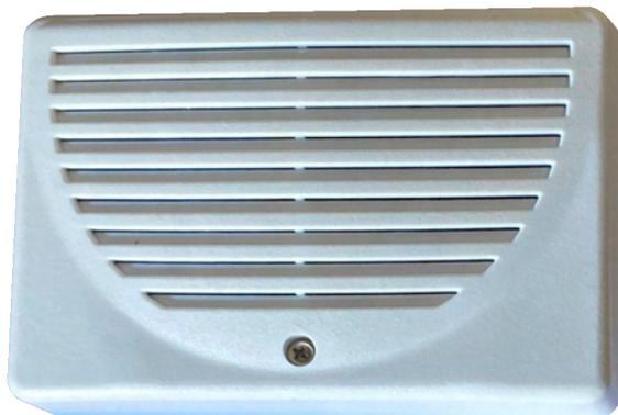
**SS-SPS** Sirena bitonale con un **diffusore alta resa piezoelettrico**. Pressione acustica **120 dB**. Collegamento con **morsetti polarizzati**. **Circuito antimanomissione** contro: l'apertura e lo strappo dal muro, Utile come deterrente di allarme interno. **Fissaggio a parete**, tramite i fori di fissaggio interni. Alimentazione da 9 a 15 Vcc. Nominale 12 V. Assorbimento 350 mA. Contenitore in plastica ABS con fori di fissaggio. Dimensioni di ingombro L136XH96XP45 mm. Peso 170 gr.
