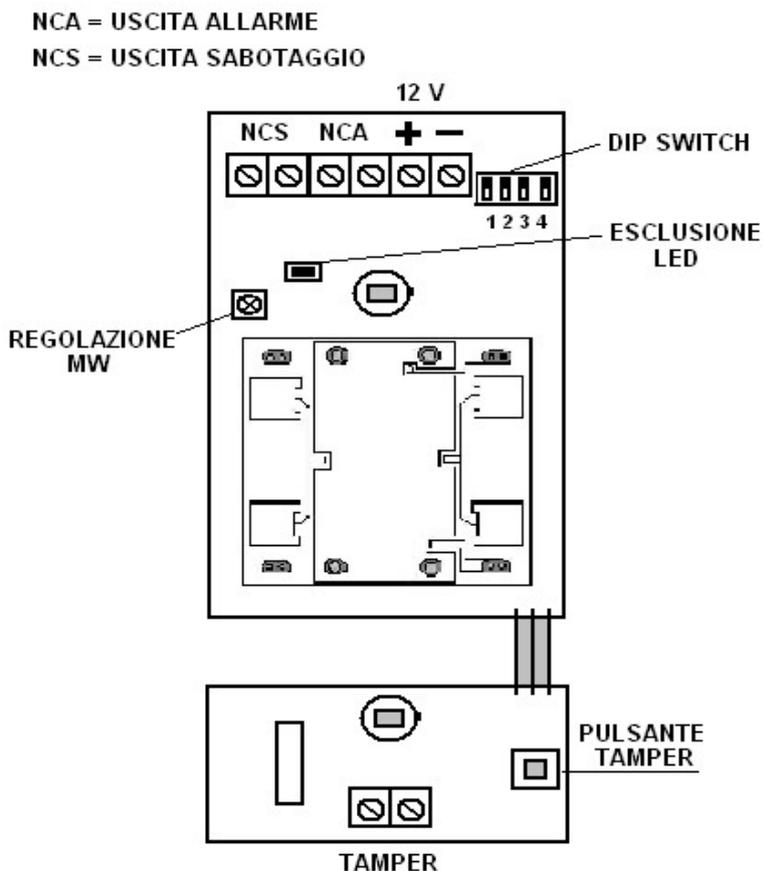
Terminati i collegamenti richiudere il sensore ed alimentarlo. Una volta alimentato si accendera' un led ROSSO lampeggiante per circa 25 secondi durante i quali si svolgera' un CHECK di funzionamento.
