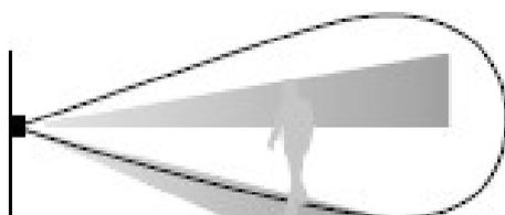
La persona viene rilevata da tutte e tre le tecnologie pir alto pir basso e microonda per cui si attiva lo stato di allarme (se in modalità AND)
