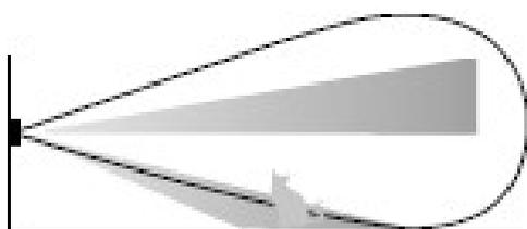
L'animale viene rilevato da due delle tre tecnologie, pir basso e microonda per cui l'allarme non si attiva (se in modalità AND)
