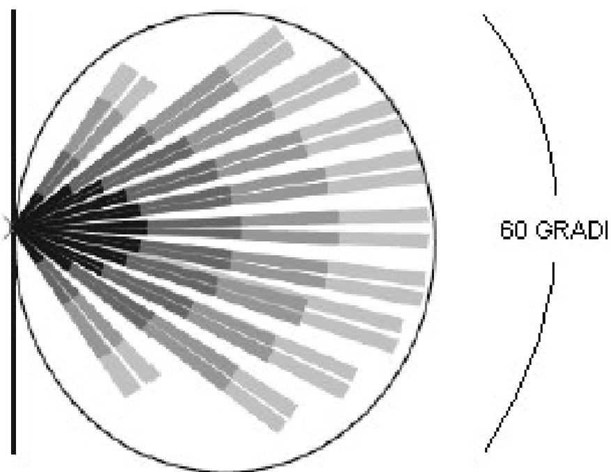
Una volta scelta la configurazione operativa desiderata allentare la vite presente sulla basetta inferiore e regolare la portata del sensore secondo lo schema seguente:
