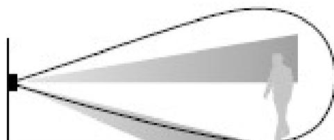
La persona viene rilevata da due delle tre tecnologie, pir alto e microonda per cui l'allarme non si attiva (se in modalità AND)
