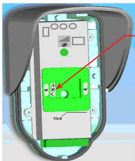
Per ottenere una tenda tra i 12/15 mt Installare il sensore ad una altezza massima di 0,8 mt, ideale a 1,0 mt.
