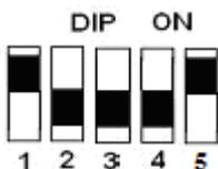
Di serie i DIP di programmazione vengono impostati come in figura
