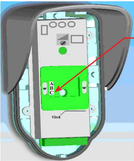
Per ottenere una tenda tra i 20/25 mt Installare il sensore ad una altezza massima di 2,3 mt, ideale a 2,1 mt. con staffa inclinabile
