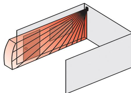
Il sensore utilizzato per rilevare movimento di intrusi da 20/25 metri esterno; va montato a parete, ad una altezza di 2,1/2,3 metri di altezza e regolato meccanicamente come da istruzioni, programmato A-B-C e tarato come riportato a pagina 6. Se esistono disturbi escludere la Microonda
