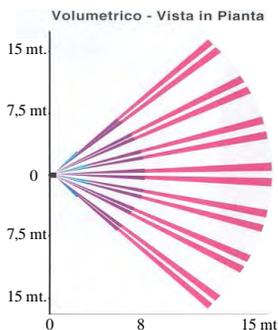
Diagramma di rilevazione con fissaggio a 2,1 metri dal pavimento. Il diagramma è visto dall'alto in orizzontale. La protezione volumetrica è 98 gradi dal centro sensore per una lunghezza di 15 metri, con 18 fasci disposta su 4 zone antistrisciamento.
