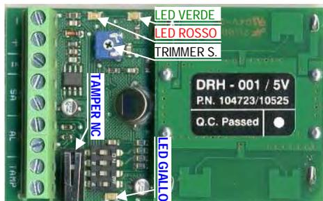
Dip 1 **ON** = Funzione avviso attivata: a sensore inibito, qualora uno dei sensori venga accecato o guasto, al 50° allarme del sensore funzionante; il sensore non funzionante si autoesclude e lampeggia il corrispondente led; si allarma l'uscita SA (da NC a NA).
