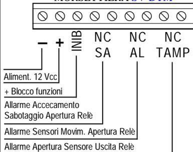
Applicando un + sul morsetto INIB+ si ha l'inibizione o blocco della Doppia Tecn. Nello stato in cui si trova, se è andata in allarme i led rimangono accesi. Si spengono o resettano quando si toglie il + dal morsetto INIB
