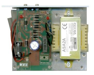
SS-CB2 Carica batterie stabilizzato, alimentatore. Ingresso 220 V. 50/60 Hz, con fusibile di protezione. uscita 13,8 V cc. 1,8/2 A. Segnalazione di erogazione corrente tramite led. Fusibile 315 mA ingresso 220 V. Fusibile 5 A uscita. Montato su staffa di alluminio a L. Adatto come carica batterie. 2 da 12 V. Utile come ricambio per centrali antifurto convenzionali e alimentazioni supplementari. Comunque è un componente da interno apparato a giorno. Dimensioni L144XH92XP105 mm. Peso 1.142 gr.
