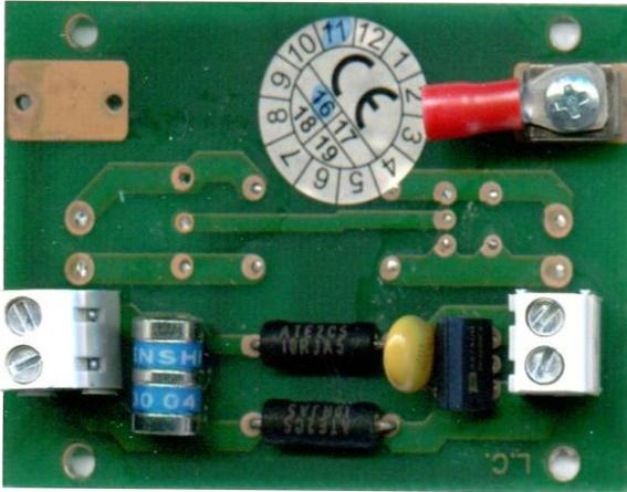
**SS-PRT** Scaricatore di **sovratensioni per linea telefonica**, PSTN con tensione di esercizio fino a 200 V. **Scarica a terra** entro un miliardesimo di secondo, tutte le sovratensione trasversali e longitudinali, **correnti indotte, parassite, elettrostatiche**. Indispensabile per **strutture isolate**, o di campagna. Controlla senza disturbare tutte le linee telefoniche e citofoniche. Non disturba non rallenta la velocità ADSL. Dimensioni L135XH85XS15 mm. Peso 26 gr.
